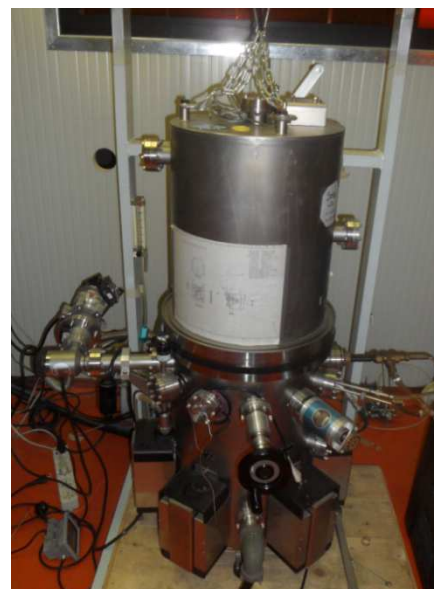
Figura 3.8: Sistema EBPVD utilizzato.
