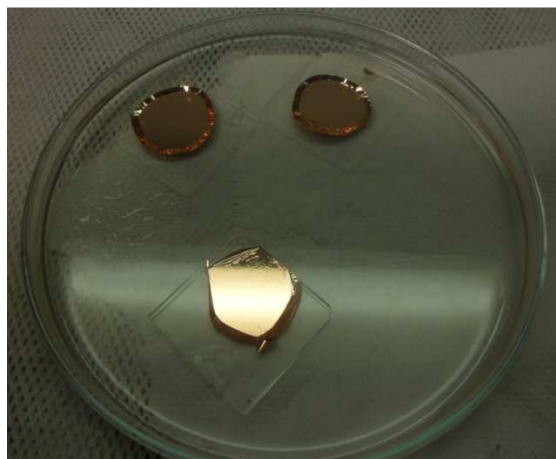
Figura 3.6: Fase di lift-off, campioni di prova immersi in acetone.
