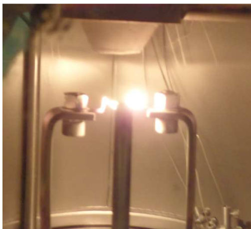
Figura 3.5: Evaporazione termica del rame su campioni di prova, formazione della pallina di rame fusa.
